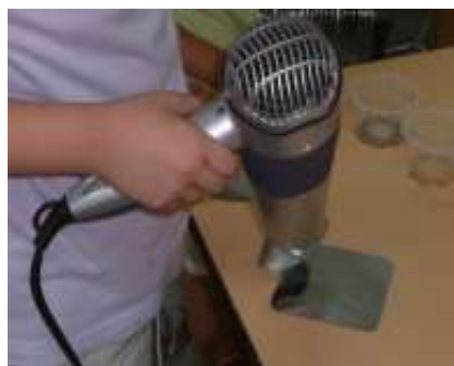
圖：吹風機的熱風、冷風可以迅速除掉鏡子上的霧
