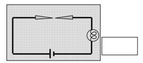
十一、準備一台四驅車,將其車體上的塑膠殼拆下。在電池、馬達之間,再多加一個底片盒, 裡面放滿鋁箔球。在四驅車的旁邊使用點火槍,觀察四驅車是否會因電路導通而起動。 並觀察四驅車撞到障礙物之後,會不會自動斷電。
