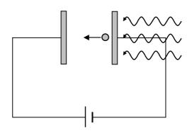
更有可能因爲電流的流過,使得鋁箔球之間互相吸引,拉近彼此距離,縮小了空隙,使得電荷能不斷的流過鋁箔球。就像用手擠壓底片盒內的鋁箔球,可看到 LED 發亮的原理是一樣的。除非,受到外力敲擊,鋁箔球受到晃動,彼此間的空隙又拉大,整個裝置又回復到斷路。根據上網查到的資料,本實驗裝置其實就是一種簡易的金屬屑檢波器,而且當電磁波通過時,金屬會擠在一起,讓電流較容易通過,此現象稱爲「鐵屑效應」。
