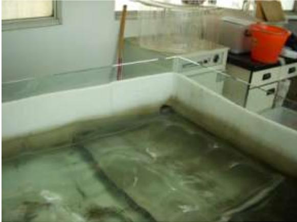
←（圖 6-13）因一開始推波器啟動後波浪過於複雜，與實際海岸有些落差，故以過濾海綿做消波用途，以達模擬真實情形。
