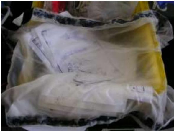
←（圖 6-14）做兩塊布以磨鬼粘貼相黏，推波模擬停止後，得以拉起沙子測量其重量。
