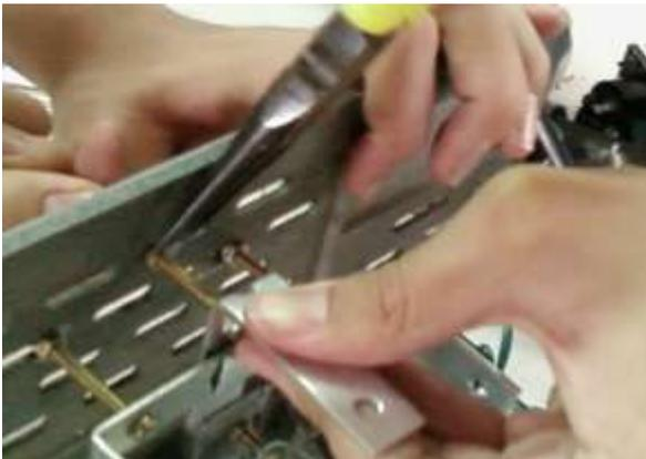
← (圖 6-2) 用螺絲及螺帽鎖住，後以白膠加強固定作用。
