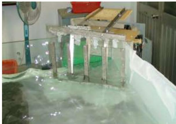
← (圖 6-11) 測試製波板斜 45 度角至於水槽邊。
