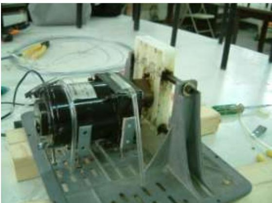
← (圖 6-4) 以水管及鐵絲再加以固定，以確保達最大的馬力。
