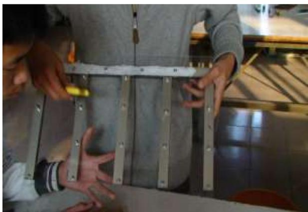
←（圖 6-7）選用較輕的壓克力板，但因在推水過程中會受水的反作用力而彎曲，故以鋁條固定使硬度增加。
