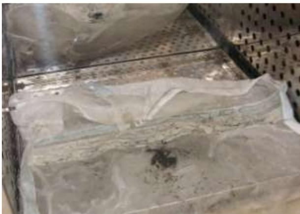
←（圖 6-18）將撈起後的沙子送進乾燥箱烘乾。
