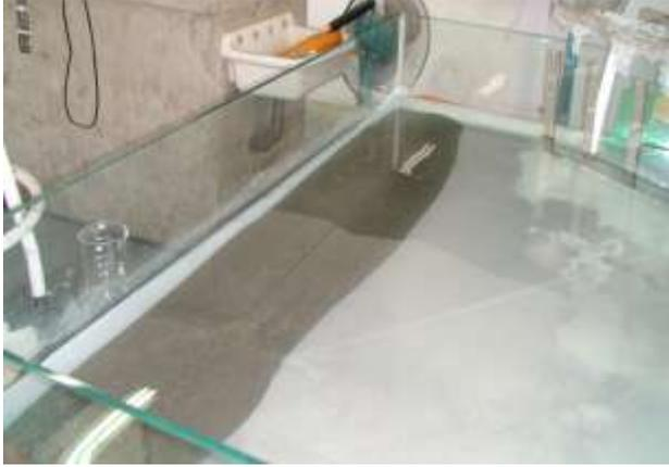
← (圖 6-9) 將 25 公斤的沙子洗淨為細砂，放置水槽一旁，成沙灘狀。
