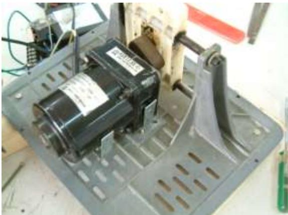
← (圖 6-3) 馬達放置且帶動前端控制盤。
