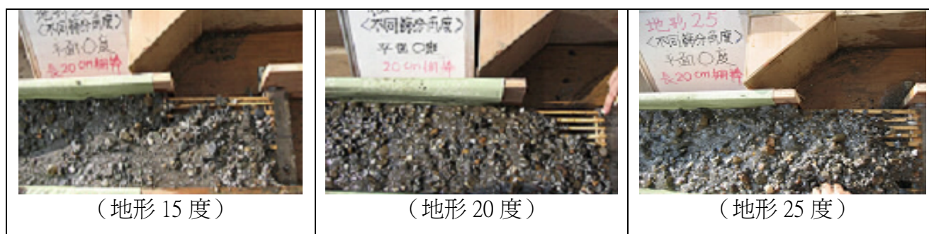
5-8 照片 傾斜地形坡度不同平面柵堆積比較照片（平面柵棒 20cm、柵棒間隙 1cm）
