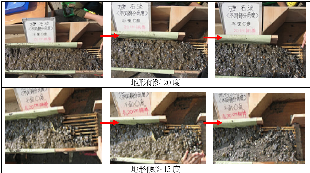
5-10 照片 土石流過平面柵連續照片
