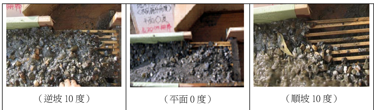
5-13 照片 不同篩分角度的柵面土石量比較照片（地形 15 度、20cm 柵棒）
