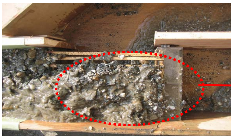
5-16 照片 土石落入主河道實驗照片
