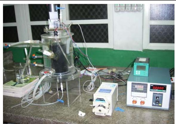
圖 13. 攪拌式反應器系統裝置圖
