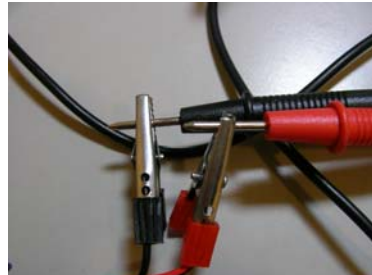
照片 6 鱷魚夾的另一端夾住電壓表的接頭。
