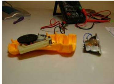
照片 8 左為發電機部份、右為燈泡及其他零件部份。
