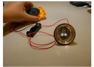
照片 24 用手連續按壓發電機，看燈泡有無發亮。
