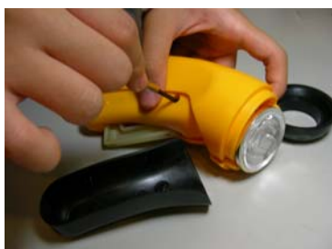
照片 1 用螺絲起子拆解手壓發電手電筒。
