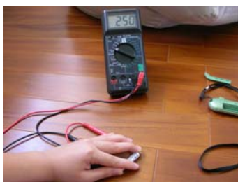
照片 104 測量電池的電壓。
