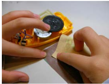
照片 17 用砂紙將線的前端磨乾淨。
