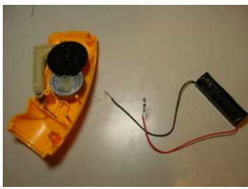
照片 20 發電機焊上二極體及電池盒。
