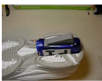
19. 發電機裝置於鞋底的凹槽中。
