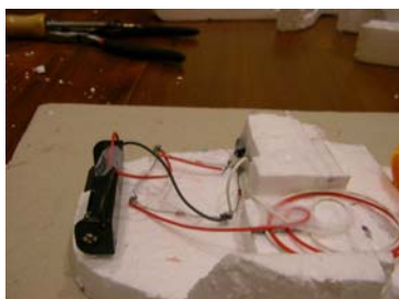
22. 其餘電路零件（橋式整流電路、電容、電池盒）則置於鞋尖部份。
