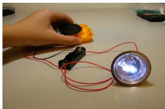
照片 114 接上二極體後按壓發電機，燈泡也跟著亮了。
