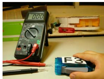
照片 112 按壓發電機，記錄其電壓。
