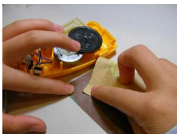
照片 4 用砂紙將線的前端磨乾淨。
