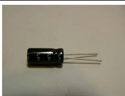
照片 33 可穩壓的電子零件－電容。
