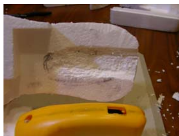
23. 在鞋蓋的下方挖出一橫溝，以配合發電機上方凸起。
