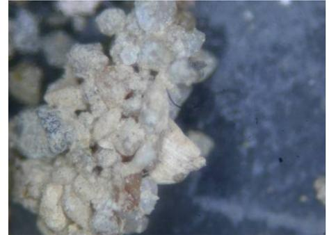
(3)在顯微鏡下觀察晒乾的未膠結溶液：
