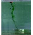
**的漩渦半徑較小，但被捲入後在水中滯留打轉的時間較久，被漩渦和反漩渦拉扯的距離也較大。**物體的長度越長、重量越重時，被捲入的漩渦半徑也越大，但在水中滯留打轉的時間較短，被漩渦和反漩渦拉扯的距離也較小。
