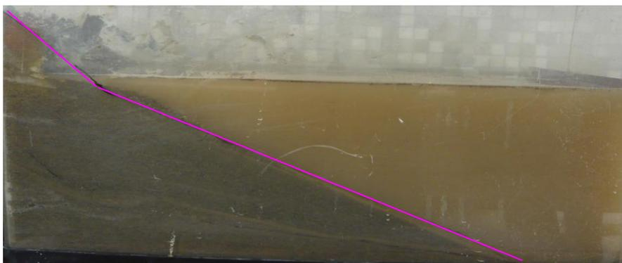
結果:不論是何種坡度,靠近海岸的地方會因為海浪侵蝕及搬運作用,而形成一個水平的的平台,且坡度愈平緩,形成的平台愈大,就如同我們所見的沙灘一樣。當海底坡度在5度時,沉積物會隨者海底坡度均勻的堆積,坡度10度時,靠近海岸線的地方,易受海浪侵蝕,被侵蝕下來的沙子會往更下方沉積。坡度到了15度以上時,侵蝕下來的沙子直接到底部沉積。採集點的岩層,如果發現岩層厚度由山到海有漸增的趨勢,可知這是在靠近海岸邊沉積而成的。如採集點8,圖十六,由頁岩層的上下兩個不連面,各畫兩條線,這兩條線的交點就是當時的海岸線位置,這兩條線的夾角就是當時的海底坡度。
