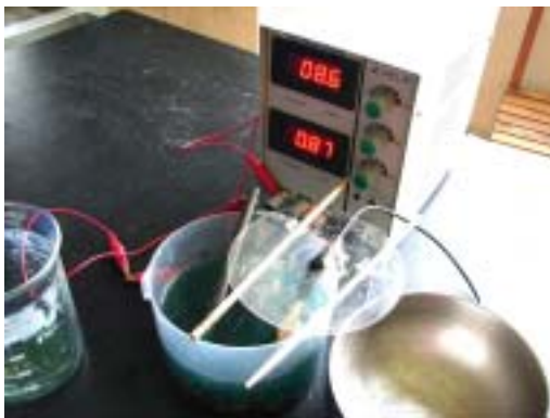
(C) 碳棒實施電鍍鎳裝置圖示。
