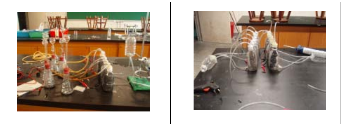
圖十九、第五代設計：6 組保特瓶燃料電池串聯設計。
