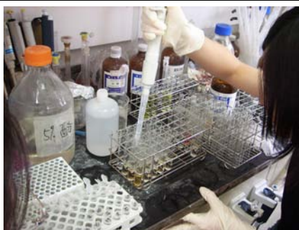
圖 29. 酚硫酸法檢測含糖量
