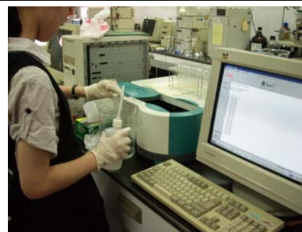
圖 30. 分光光度計檢測含糖量
