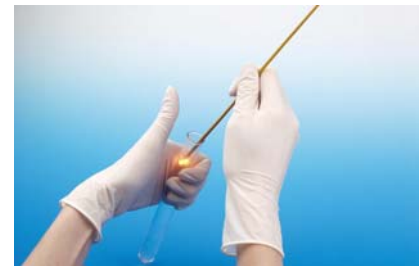
◎ 以點燃（有火焰）的線香檢查試管 B 內的氣體
