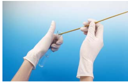
◎ 以留有餘燼的線香檢查試管 A 內的氣體
