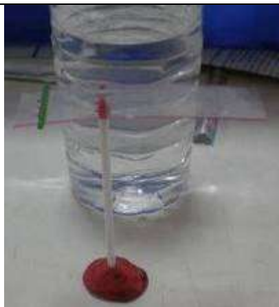
模擬種子的水平重心測量裝置
