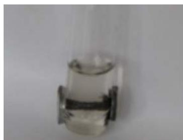
圖 1.6 在水中兩磁鐵 N 極和 S 極也同樣形成磁力線，使鐵粉連接起來
