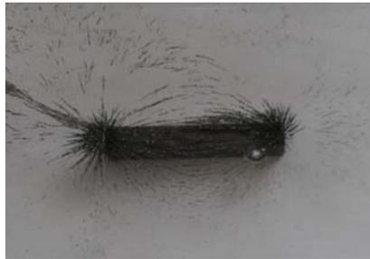
圖 1.1 磁鐵上方的磁力線排列
