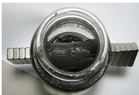
圖 5.3 加入磁場，鐵粉油液馬上變硬
