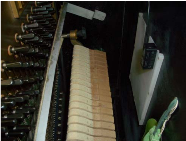
圖六 測量時安裝在鋼琴內部的領夾式麥克風。圖七 鋼琴發音頻率的測量情形。
