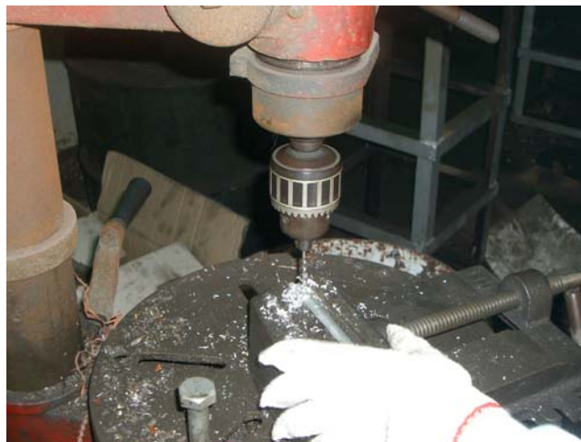
圖十六 圓形鋁棒鑽孔情形。
