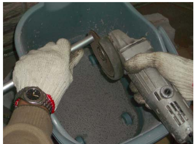
圖二十一 調整鋁棒長度以調整其發音頻率。
