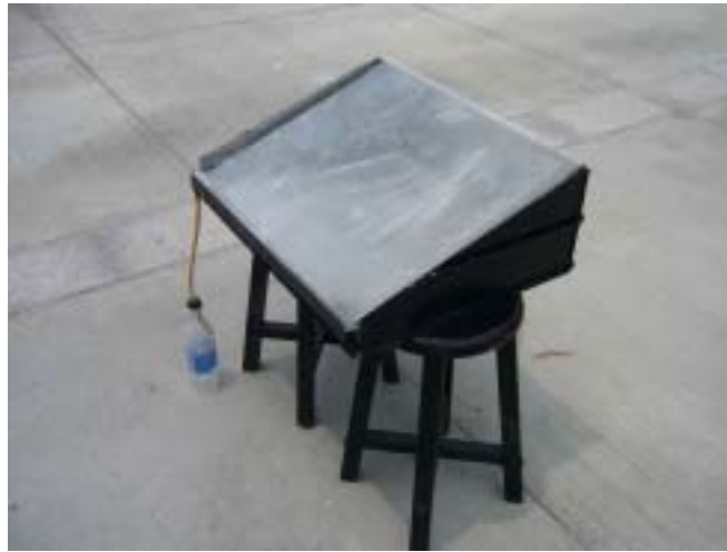
圖 10：最佳海水淡化槽測水滴生成量
