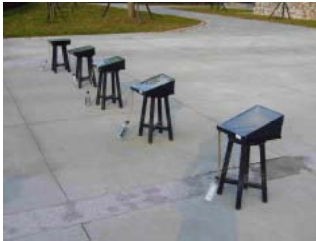
圖 3：不同的玻璃面傾斜度對水滴生成量的影響
