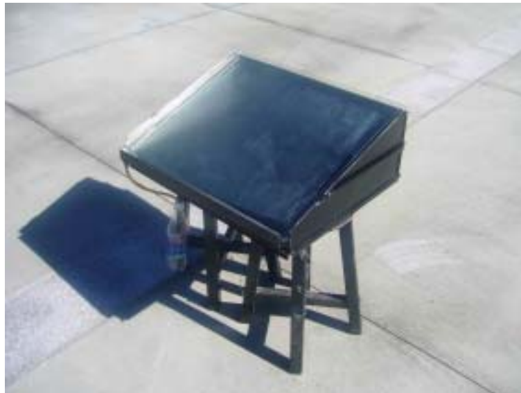
圖 11：以海水淡化槽進行汗水處理
