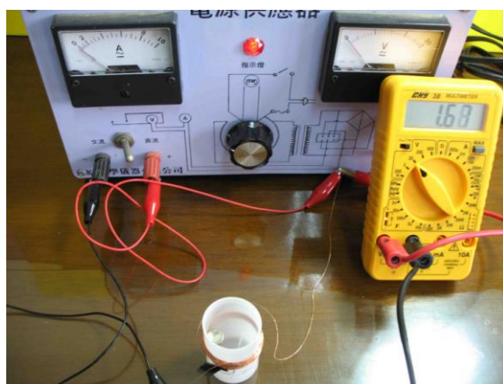
圖 2 .利用電源供應器測試
