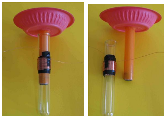
圖 32. 第一代自製秤盤（大吸管）
