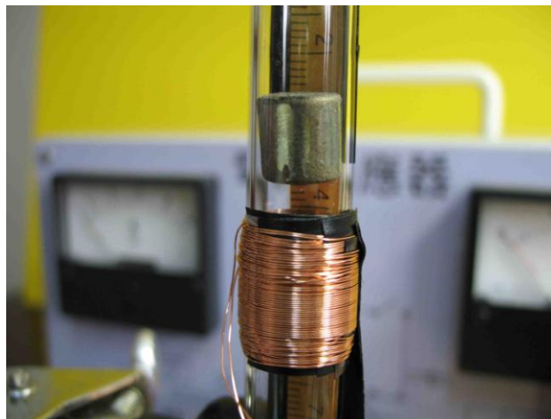
圖 4.強力磁鐵和線圈相斥的現象
