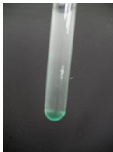
圖 22 高濃度比例的丙酮與硫酸鎳及 CO 反應情形
