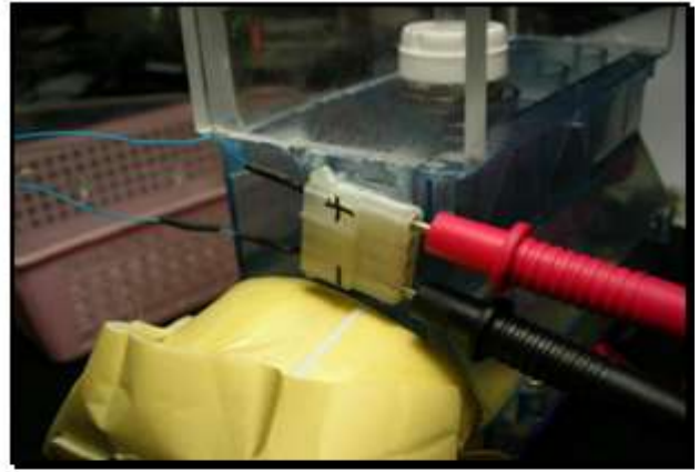
圖：聯想與應用生活中廢棄的玩具模型，加以拆除，進行研究與重新組裝，設計發電管套插座組體與自創電路測試系統，加以安裝，並以導線連接電壓測試頭與電錶測試插座，加以焊接，逐步完成模擬海浪測試平台之研發工作。
