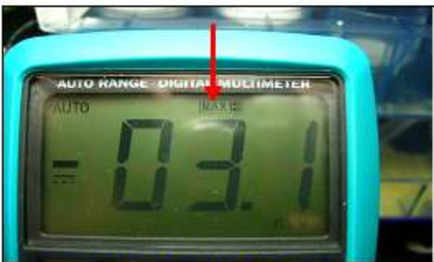
圖：按下 "MAX" 按鍵記錄最高的電壓值
