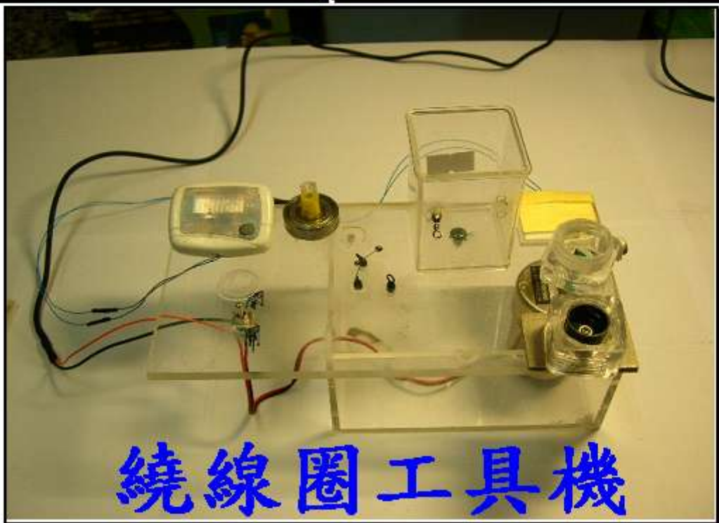
圖：當組合式方形壓克力蓋旋轉 1 次，會使磁簧管內部金屬片相接觸 1 次，電子計步器也會顯現 +1 次，再把相關物件加以設計組合，便完成繞線圈工具機
