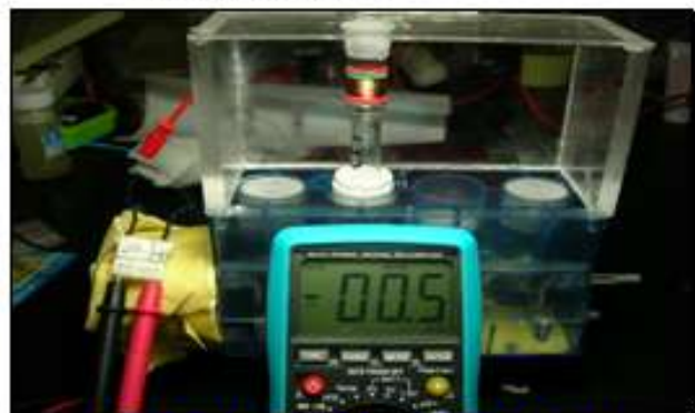
圖：自創發電管套測試組體與電路測試系統結合，成功測試發電管發電電壓效率
