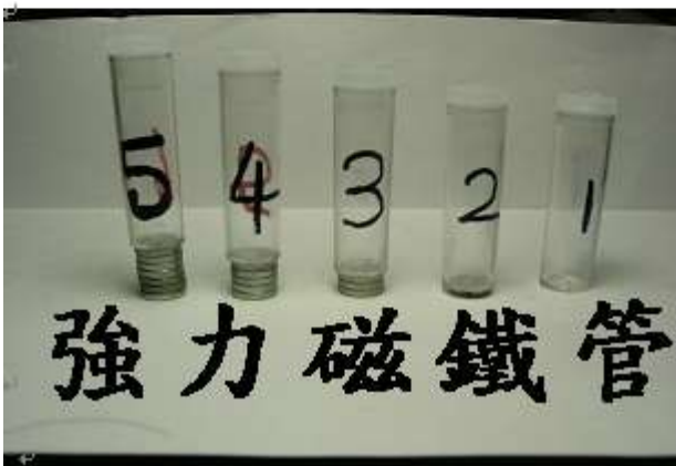
圖：1 號管:0 個強力磁鐵， 2 號管:1 個強力磁鐵， 3 號管:3 個強力磁鐵， 4 號管:5 個強力磁鐵， 5 號管:7 個強力磁鐵。
