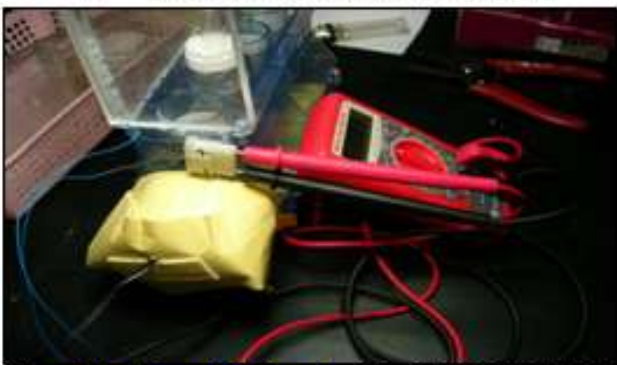
圖：自創電路測試系統(測試發電管發電電壓)
