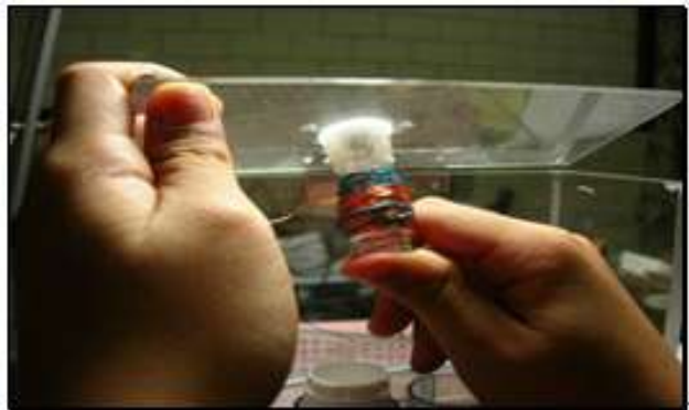
圖：將發電管插入發電管套測試插座中
