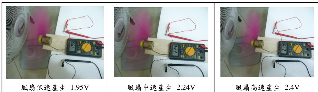
(3)選用另一顆高轉速馬達測試，雖可產生 12V 的電壓，但葉片的不易旋轉，需要將電風扇調至高速，風力夠大才能產生足夠的旋轉力矩，如此才可讓葉片旋轉，如下圖所示。
