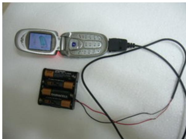
(3) 實際用三用電表量測手機配件"座充"及"旅充"所提供的電壓，發現旅充其主要是利用一變壓器，將家裡的 110V 交流電輸出成為 5V 的直流電。座充也是，但座充只有 4.2V。而該手機電池的工作電壓為 3.7V。
