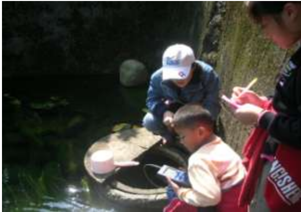
用導電儀器測湧泉池中的水質
