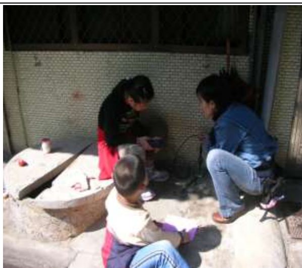
從井裡取水上來檢測導電值及水溫
