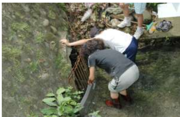
這是泉水空湧泉水的流出口，我們正在用自製的 V 型板測量其水流的高度。
