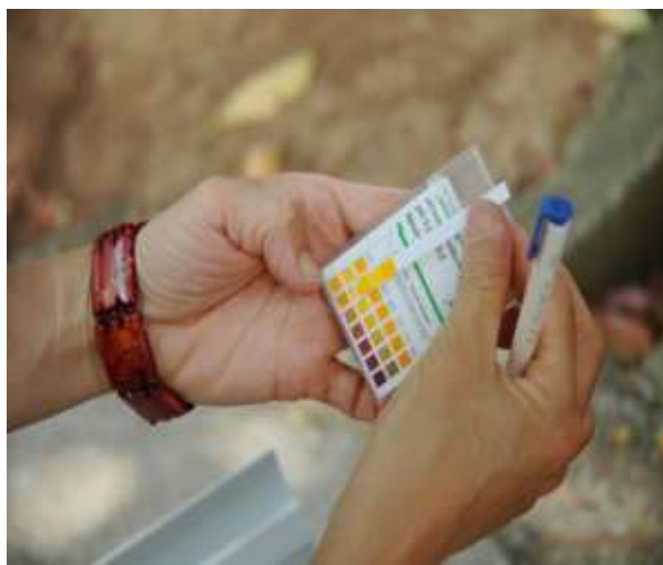
將 pH 試紙檢測湧泉後的酸鹼變化作比對，以鑑定其酸鹼值。
