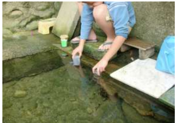
兩手同時拿著壓克力罐子收集湧泉氣泡比較快。
