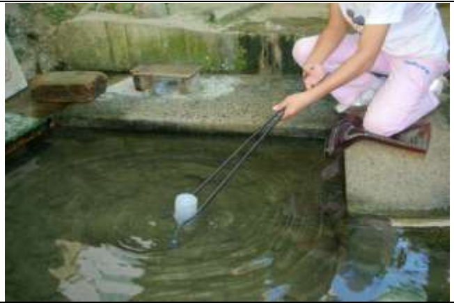
在國驕橋湧泉，用火鉗尾夾夾著塑膠瓶收集氣泡
