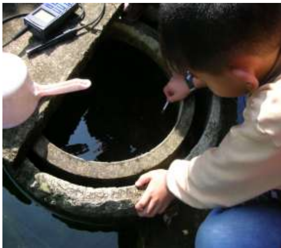
利用 pH 試紙直接在湧泉池中，檢測湧泉的酸鹼值。
