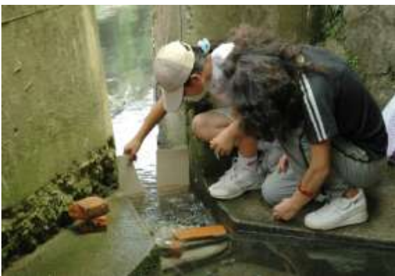
用 V 型板測湧泉流過 V 型口的高度。
