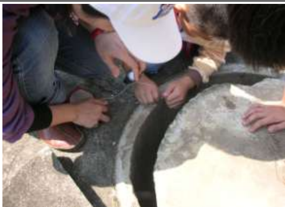
我們將綁上尼龍繩的鉛錘，垂吊入井裡，測量井水位。
