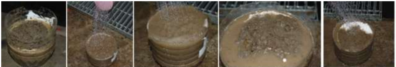
1. 保麗龍上方鋪上土石 2. 利用灑水器模擬降雨 3. 保麗龍上方土石被抬昇 4. 土石已經溢出保特瓶 5. 繼續抬昇，土石溢出
