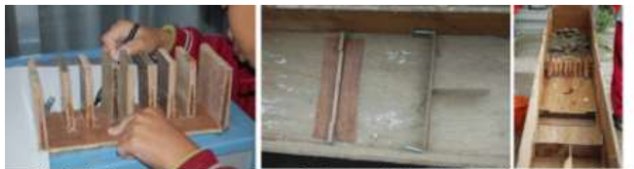
製作木板梳子壩 攔砂壩及測量器（右）固定壩體 圖 11. 各種壩體實驗過程
