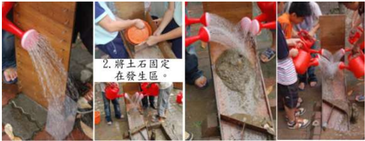
1. 利用雨量筒測量雨量。 2. 將土石固定在發生區。 3. 三支灑水器降雨。 4. 四支灑水器。 5. 五支灑水器。
