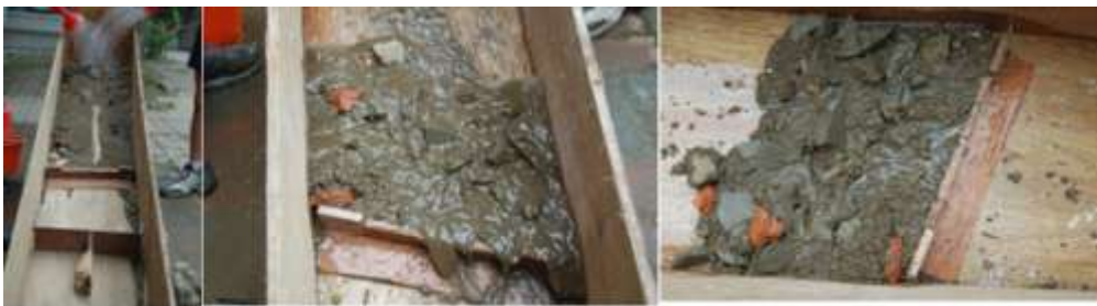
圖 31. 攔砂壩阻擋土石流實驗
