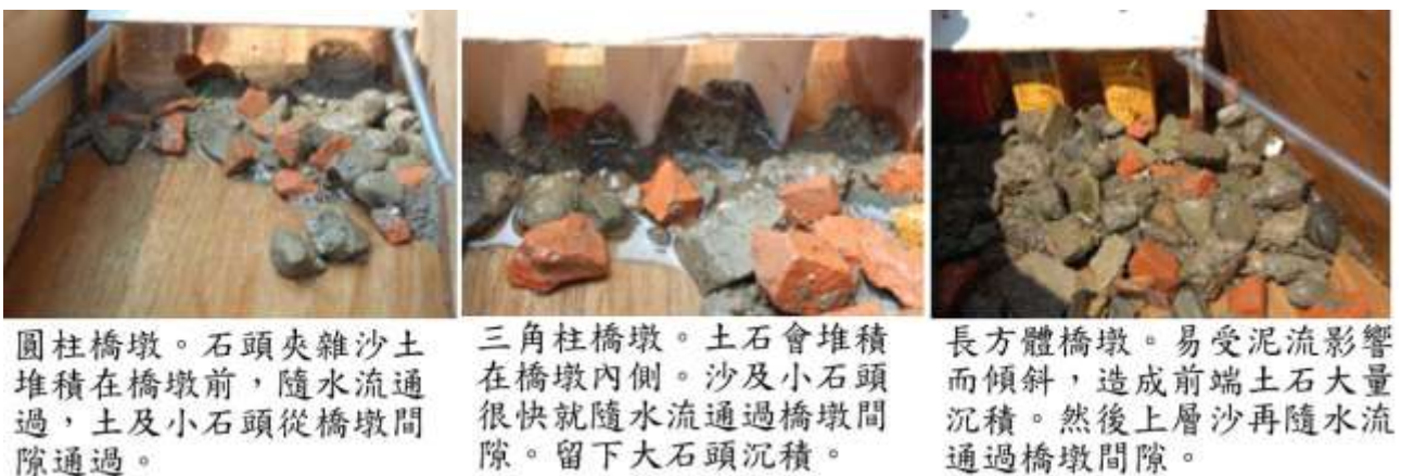
圖 21：不同橋墩形狀土石堆積情形
