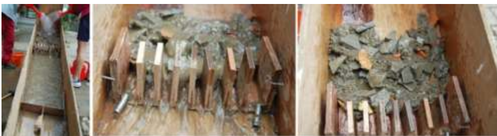
圖 32. 梳子壩阻擋土石流實驗
