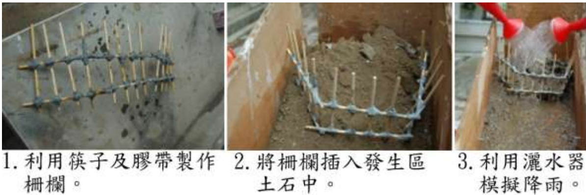
圖 13. 打樁編柵土石流實驗過程
