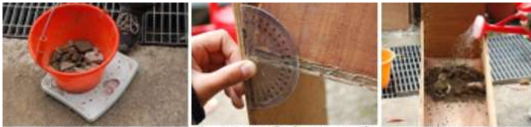
1. 利用體重計測量土石重量。 2. 利用量角器測量坡度。 3. 利用灑水器模擬降雨。
