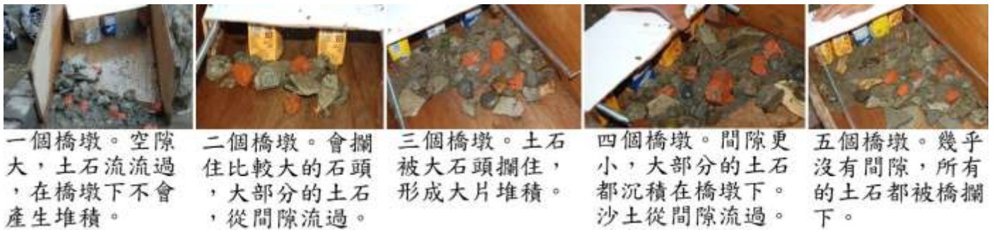
圖 26：不同橋墩數量堆積情形
