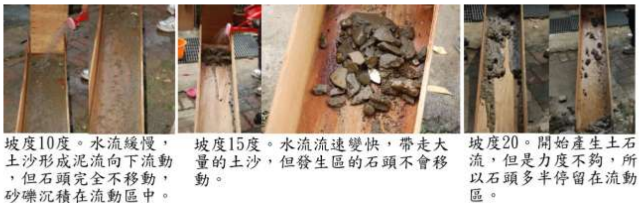
圖 17. 不同坡度土石流產生實驗
