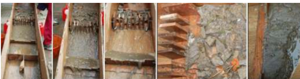
圖 33. 攔砂壩及梳子壩同時阻擋土石流實驗
