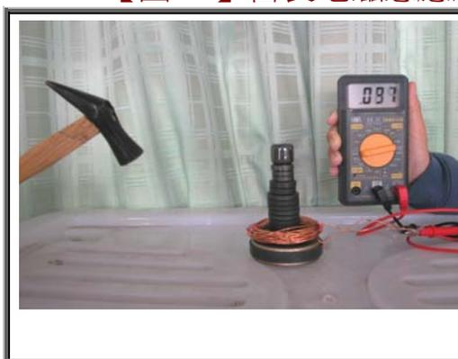
我們利用永久磁鐵、線圈以及三用電表製成電磁感應式地震儀，已獲得初步的成功，最高可產生左 180mA 左右的電流。當地面震動時可產生感應電流。而且可以利用電表讀出的電流的正負值，來分辨 P 波壓縮型和伸張型。
