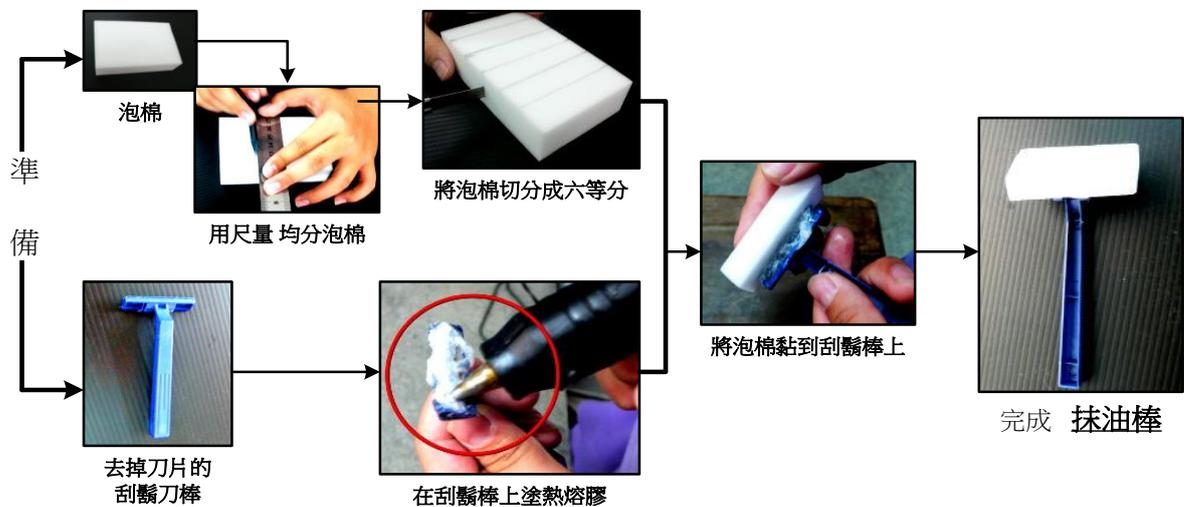
圖4-2 抹油棒的製作過程
