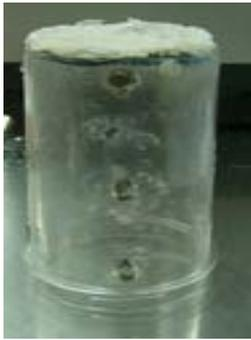
小塑膠罐直徑 8cm、高 13.5cm。各洞的距離 4.5cm。
