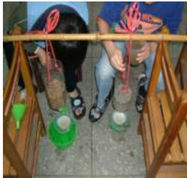
5.砂石濾水器正在過濾中
