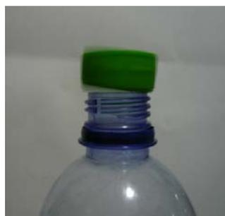
圖 21：800ml 瓶蓋跳動情形
