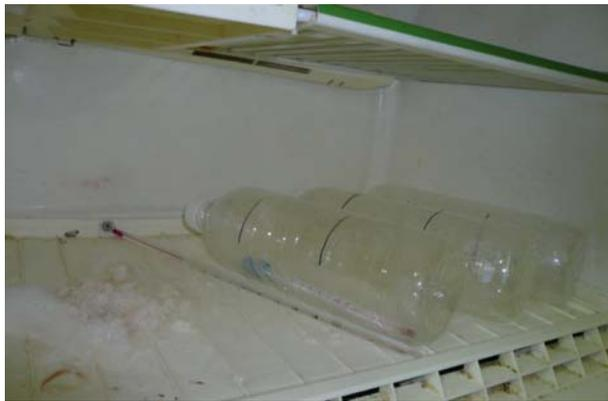
圖 7：瓶口關著冰在冷凍庫的保特瓶，保特瓶中放置迷你形溫度計
