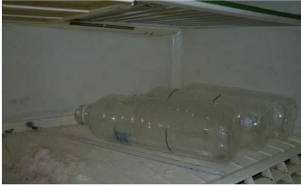
圖 6：瓶口打開冰在冷凍庫的保特瓶保特瓶中放置迷你形溫度計
