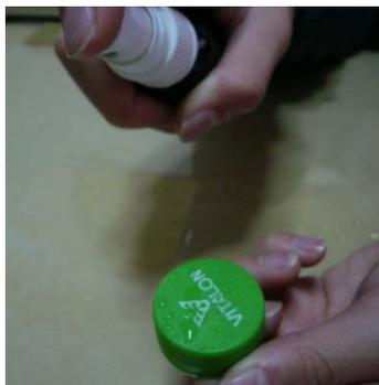
圖 25：在相同高度處對瓶蓋上噴水
