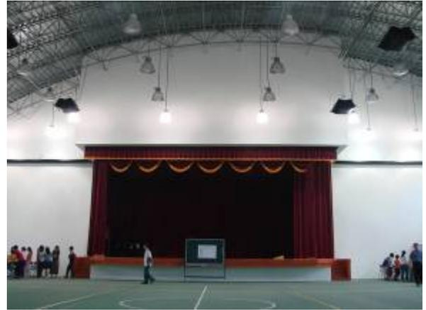
圖 4-10：裝設吸音板後的活動中心舞台
