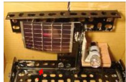
圖 6-8：右端鐵架上安裝雷射光筆及太陽能板。
