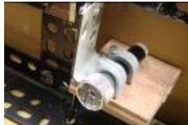
圖 6-3：以木板、水管固定夾固定雷射筆。
