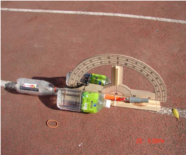
為避免發射以及大風吹動時的晃動，影響測量時數據的準確性，以裝水之寶特瓶固定發射架。
