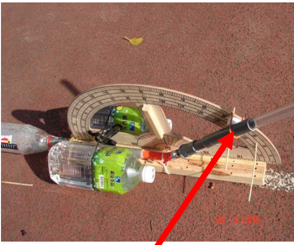
良好測量角度，固定發射管。
