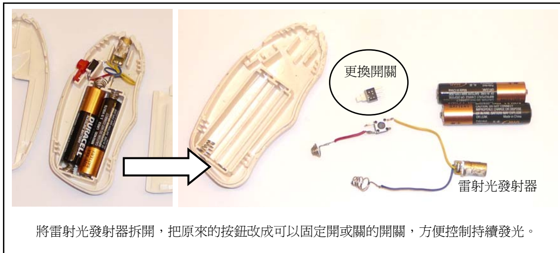
圖 4-3 將簡報用雷射光器拆開更換開關
