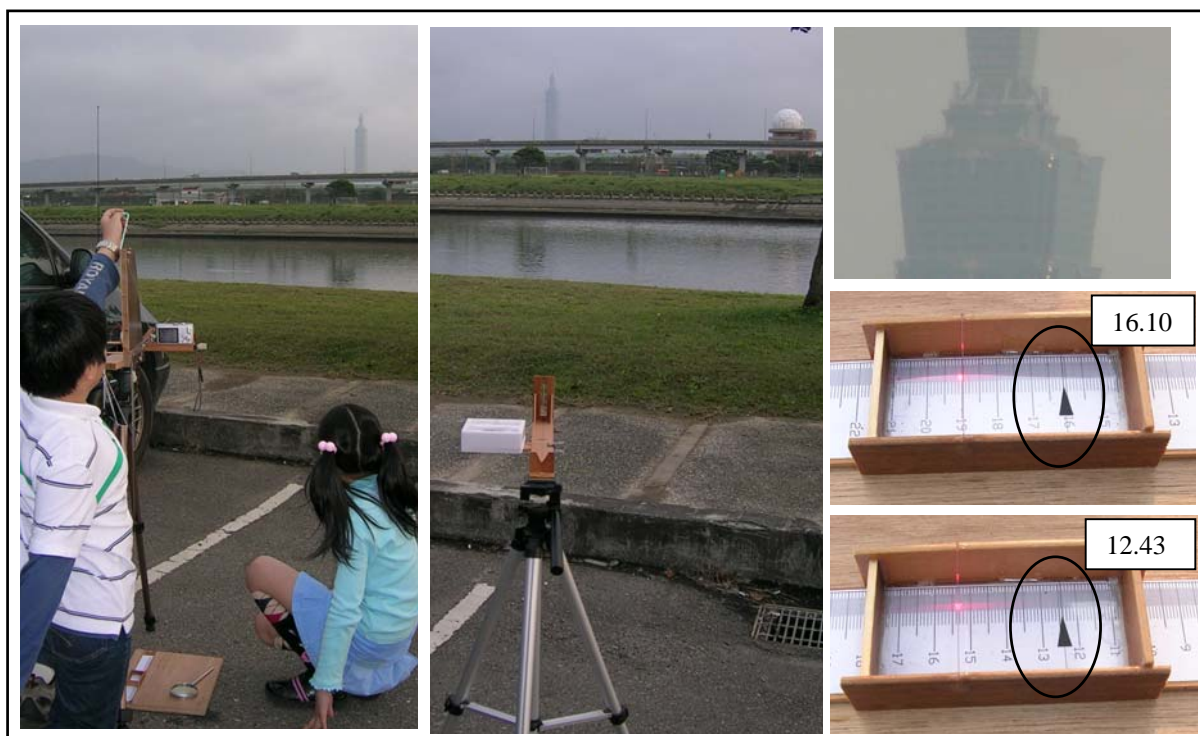
圖 4-12 大直美堤河濱公園測量與 101 大樓的距離及方位角的實驗過程
