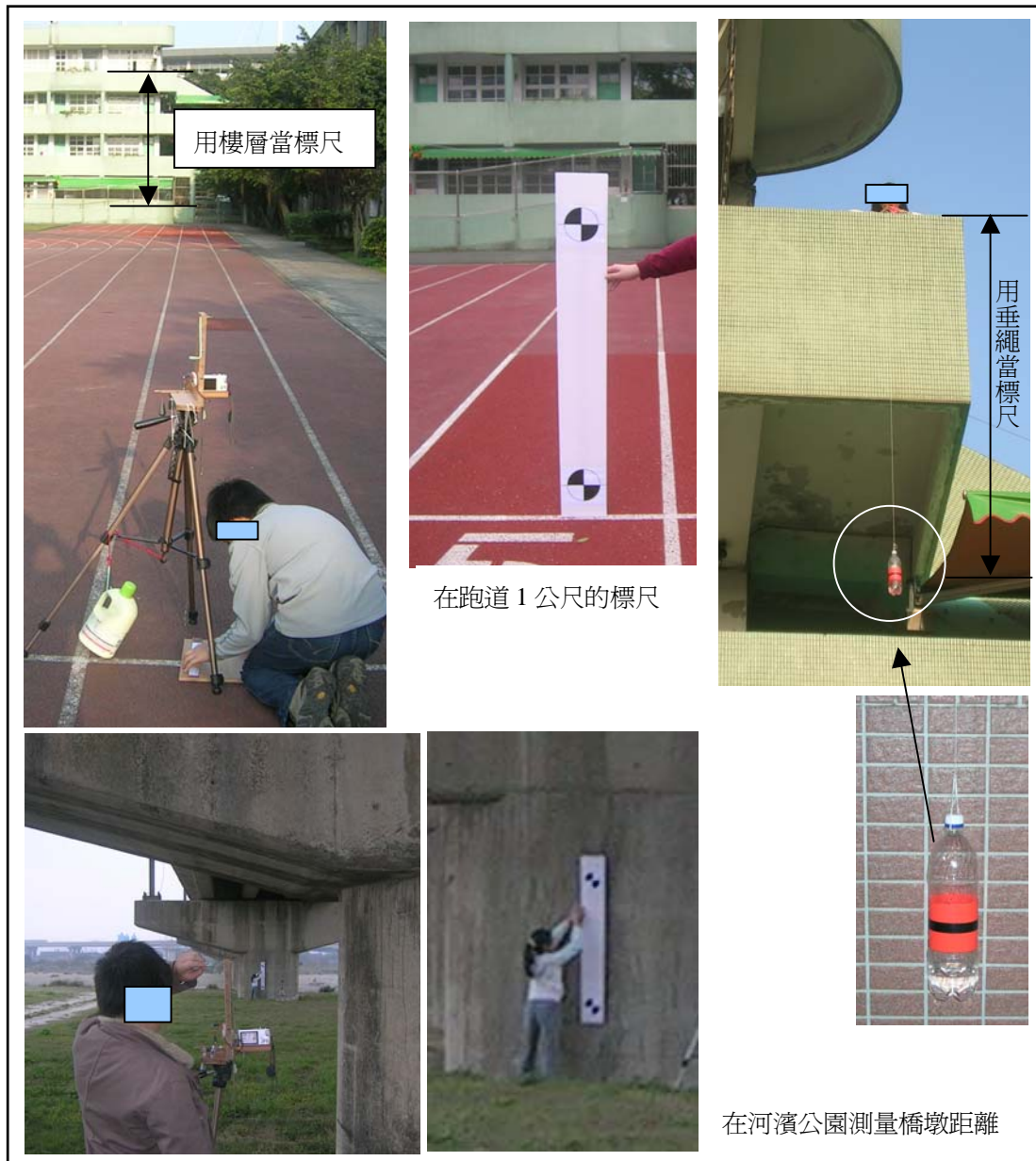
圖 4-9 中距離測量實驗各類型標尺的實驗過程
