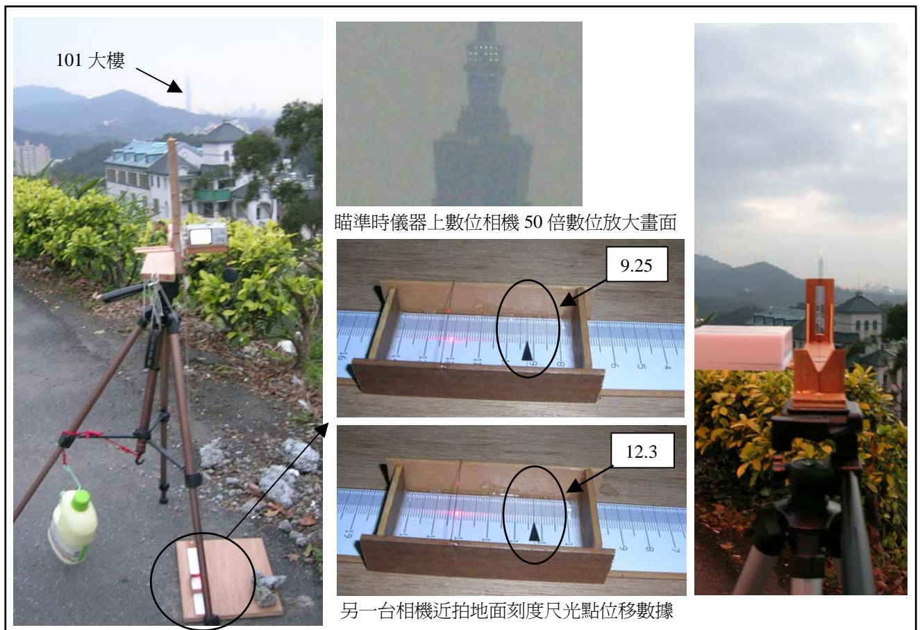
圖 4-11 汐止綠野山坡社區測量與 101 大樓的距離及方位角的實驗過程
