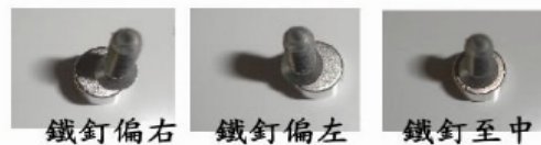
圖四、螺絲頭與磁鐵南北極接觸位置
