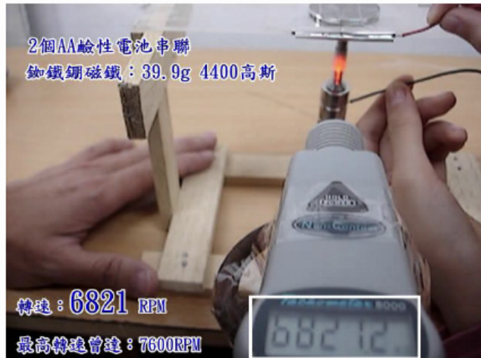
圖十七、不同重量、相同半徑與磁場的圓柱磁鐵，轉速變化。
