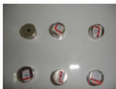
圖八、外觀、重量、材質相同，但磁場不同的釹鐵硼磁鐵。
