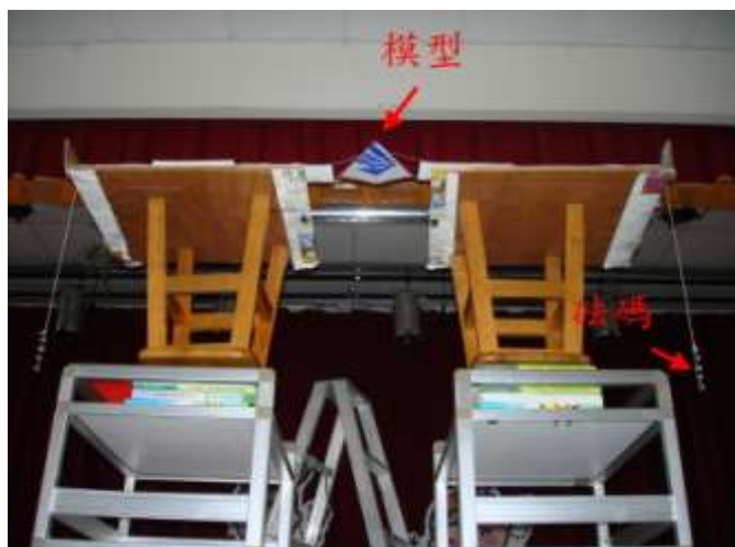
圖 32：從 3 公尺處讓模型自由下落
