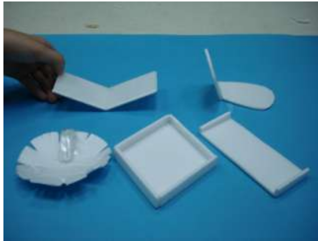
圖 61：能改善翼面搖擺的翼形
