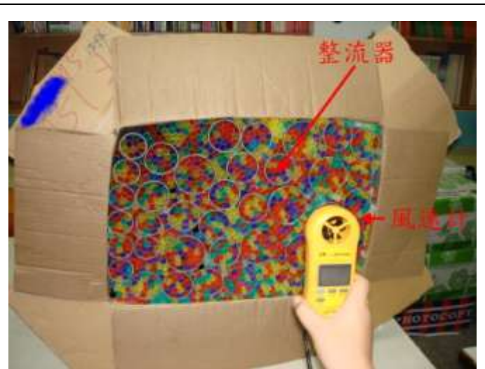
圖 27：受風吹襲實驗裝置正面
