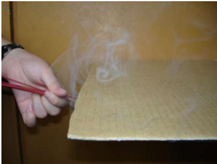
圖 60：線香在下翼面燃燒，上升的煙在上翼面造成渦流
