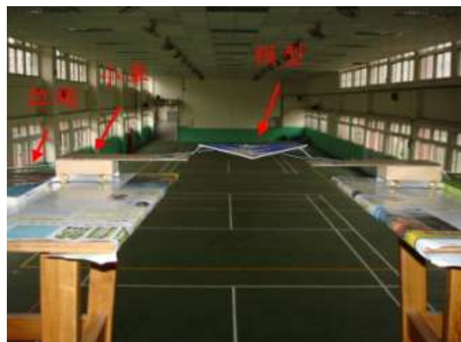
圖 33：兩小車以砝碼同時向左右拉動，模型一失去支撐力後即自由下滑
