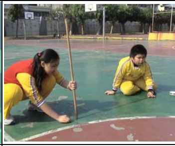
圖 11：短棍測太陽高度角
