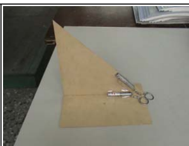
圖 2：自製 45 度測高儀器
