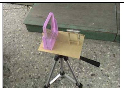
圖 3：自製鏡子測高儀器
