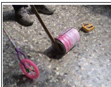
圖 1：自製測距儀器
