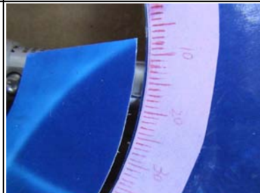
圖 39：盒形測高儀的測距量角器
