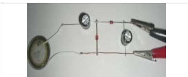
圖 26：累壓電路具有固定的正(下)負(上)端
