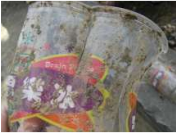
圖 19 土壤分解 4 個月的 PLA 杯
