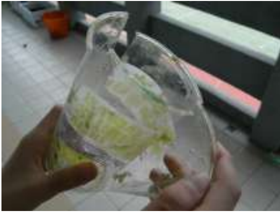
圖 35 水質分解 8 個月的 PLA 杯
