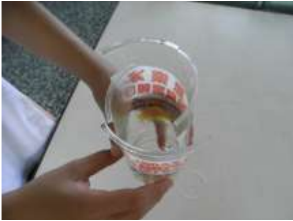
圖 27 水質分解 2 個月的 PLA 杯 (2)
