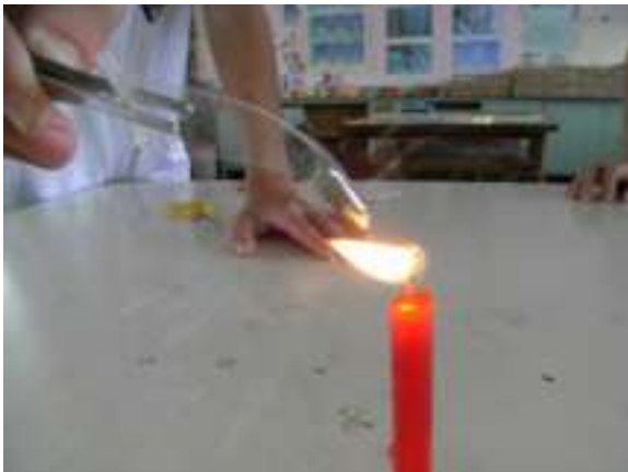
圖 63 PLA 杯遇熱軟化
