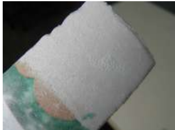
圖 62 保麗龍切片邊緣有細微腐蝕痕跡
