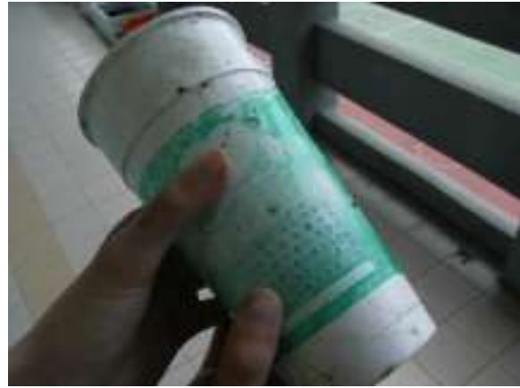
圖 36 水質分解 8 個月的保麗龍杯
