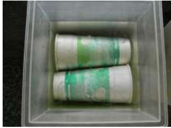
圖 26 水質分解 2 個月的保麗龍杯 (1)
