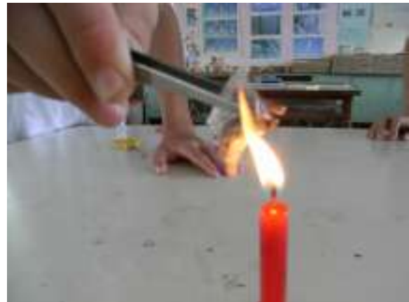
圖 64 PLA 杯遇熱有熔化現象
