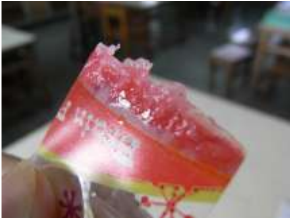
圖 57 PLA 杯切片浸入濃硫酸處都被腐蝕
