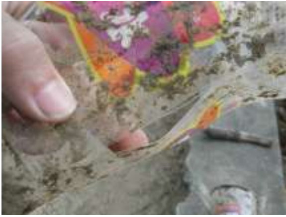
圖 17 土壤分解 2 個月的 PLA 杯
