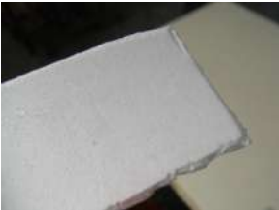
圖 61 保麗龍切片表面沒有被腐蝕痕跡
