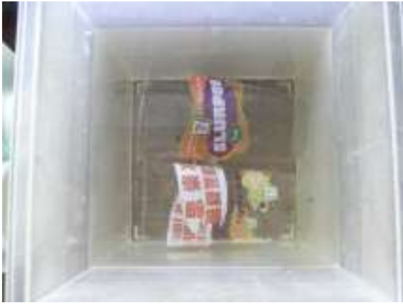
圖 25 水質分解 2 個月的 PLA 杯 (1)
