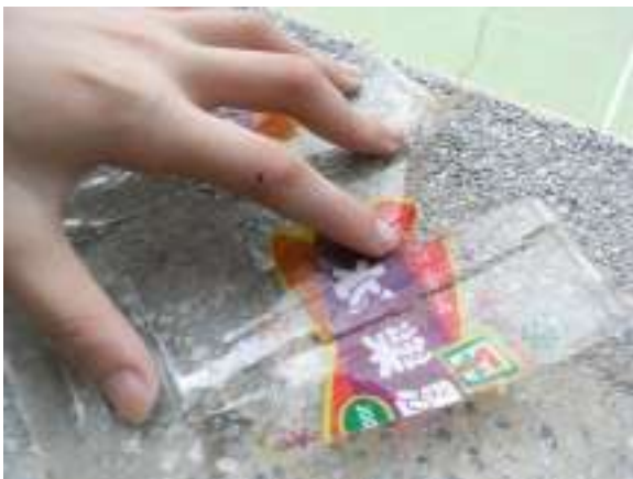
圖 23 土壤分解 8 個月的 PLA 杯
