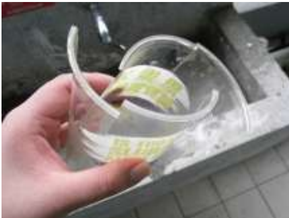
圖 29 水質分解 4 個月的 PLA 杯
