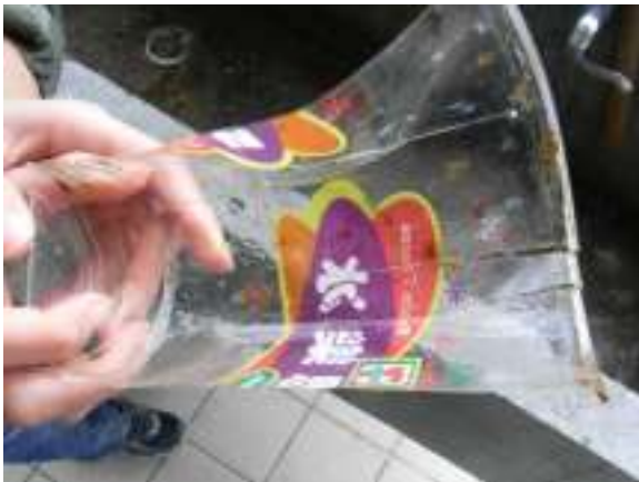
圖 21 土壤分解 6 個月的 PLA 杯
