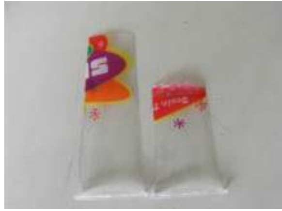
圖 58 腐蝕剩餘的切片與原尺寸切片比較
