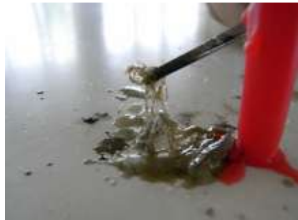
圖 66 PLA 杯燃燒後產生濃稠膠狀物
