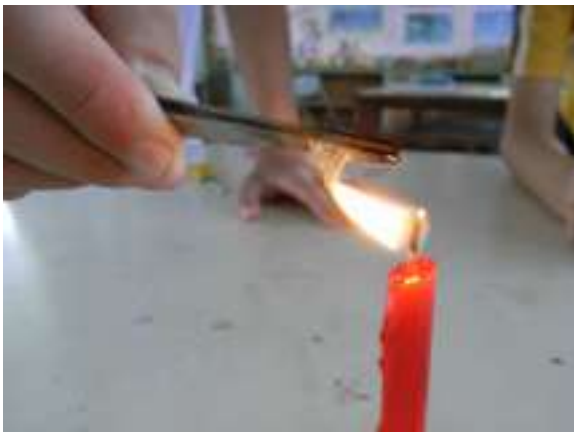
圖 65 PLA 杯遇熱熔化產生氣泡
