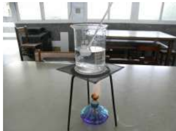
圖 38 PLA 杯切片的加熱
