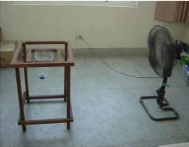
圖 7.12 風擺式雨量器，受風擺動情形
