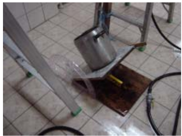
圖 5.9 進行模擬不同降雨傾斜角度實驗的情形
