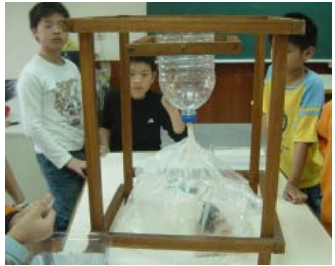
圖 7.25 浮球上浮接觸微動開關，電路導通警報大響
