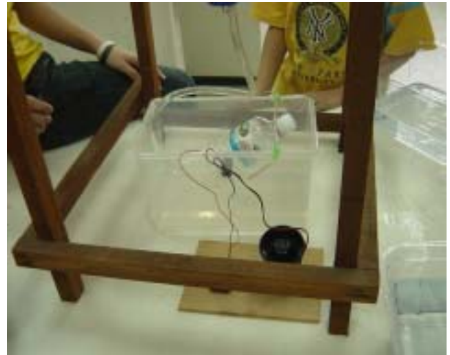
圖 7.21 雨量器及水位警報系統結合
