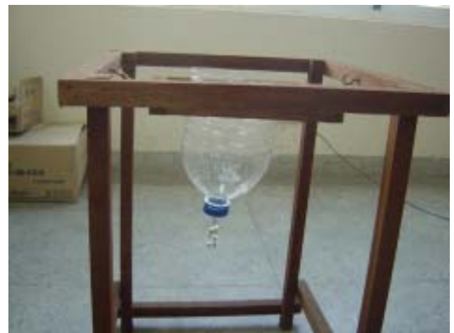
圖 7.15 地球儀擺式雨量器，受風傾斜情形
