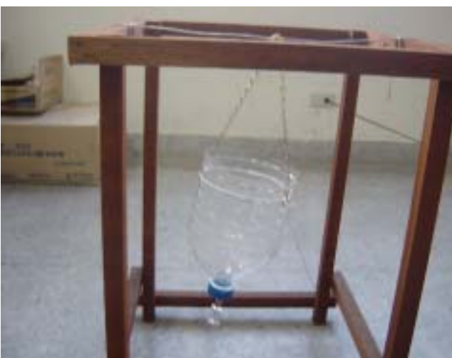
圖 7.16 吊擺式雨量器，受風傾斜情形
