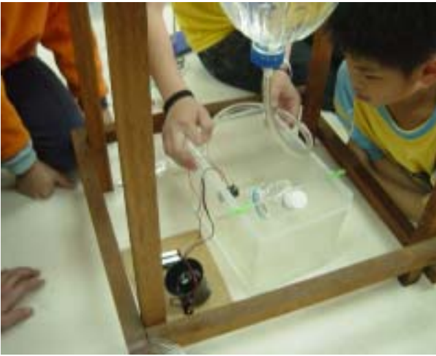
圖 7.24 雨量器收集雨水由水管流進水位警報系統
