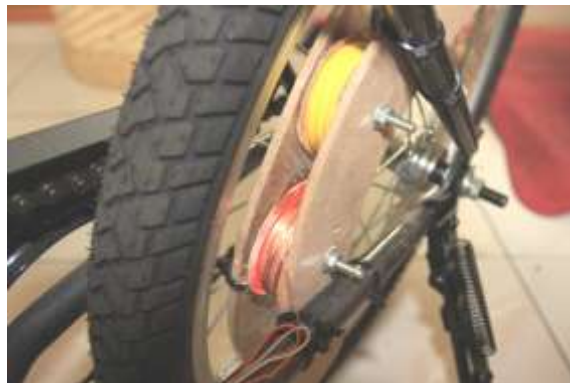
感應線圈固定於腳踏車的後支架上
