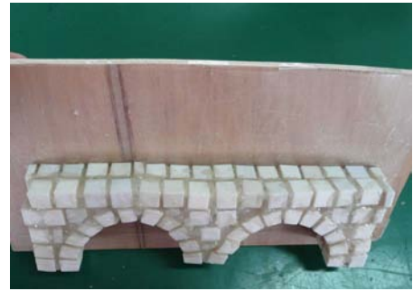
圖 138：黏貼完成第二層積木
