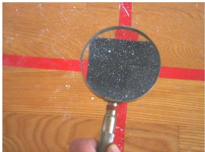
(圖 14) 採樣膠帶上的粉筆灰落塵顆粒
