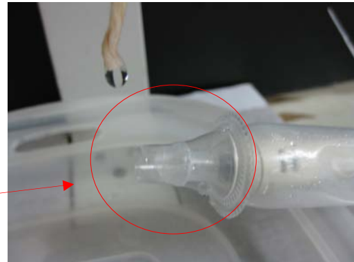
高靈敏度麥克風外覆耳溫槍套來防水(放大圖)
