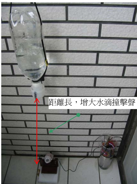
照片 12 流速分析之實驗設備擺設
