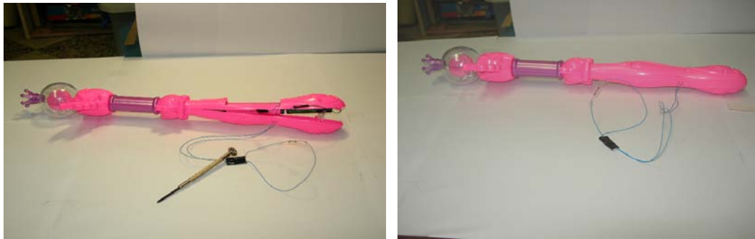
圖 5-4 仙女棒改裝由磁簧管來控制開關完成
