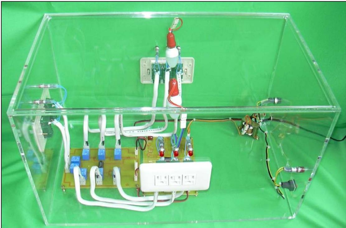
圖 14 獨立式家電遙控器實體照片
