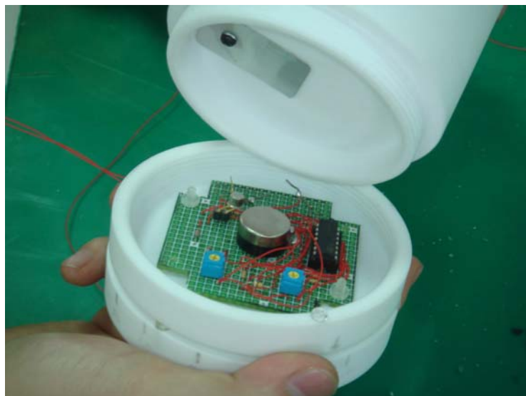
圖(十二)杯體與電路、底座、轉盤組裝
