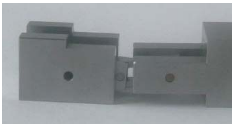
圖十七 平行墊塊本體塊與輔助塊銑削溝槽情形
