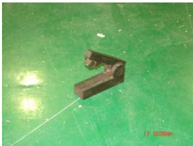
圖 45 正弦桿：先將所需使用的角度用正弦桿擺好，接著將壓克力板放在調整好角度的正弦桿
