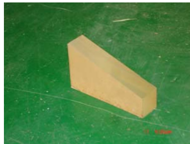
圖 46 角度規：用銑刀切割後為角度規
