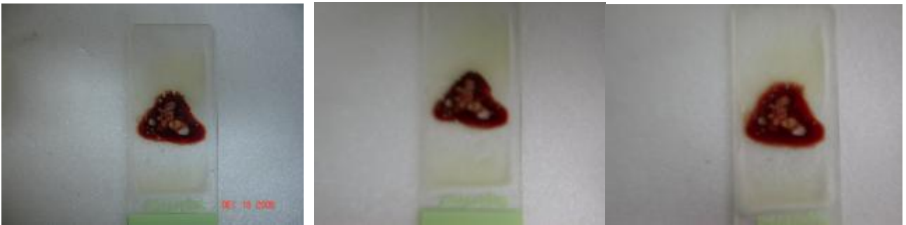
圖十一 a 照射紫外光 1 天後 照射紫外光 3 天後 照射紫外光 5 天後 圖十一 a 利用 \text{TiO}_2 酸性溶液凝膠薄膜照射紫外光，光阻液油漬變淡
