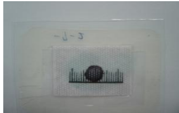
圖十六 b 以亞甲藍為光敏染料之降解效果(照紫外光 3 天)
