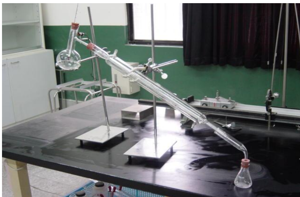
圖七 甲醇溶液經由 \text{TiO}_2 酸性溶液凝膠薄膜降解之蒸餾測試
