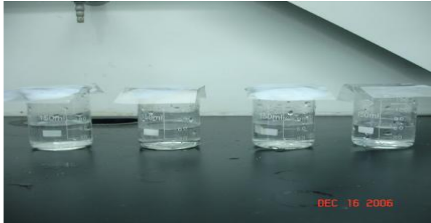
圖八 將 \text{TiO}_2 酸性溶液凝膠薄膜置放於濃硫酸附近 (由左至右：C 凝膠、B 凝膠、B 凝膠、A 凝膠)
