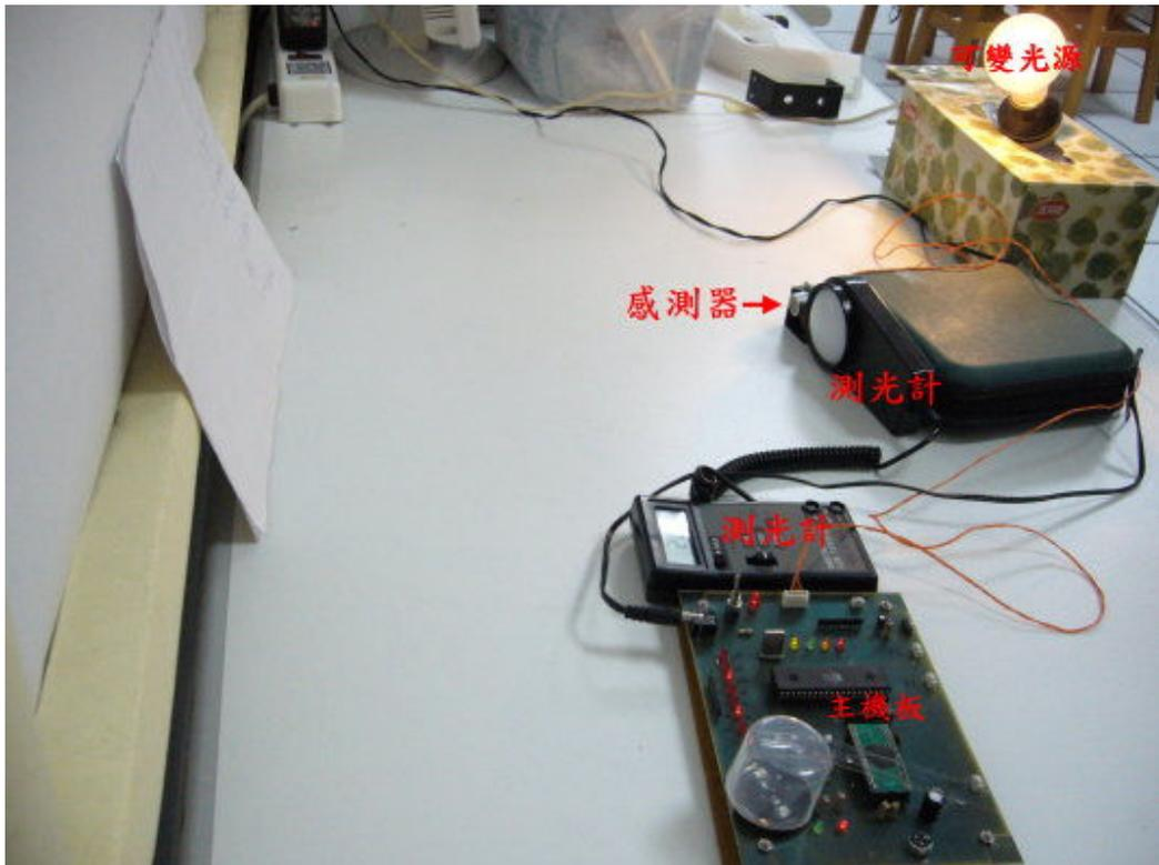
光線感測器實驗設置圖
