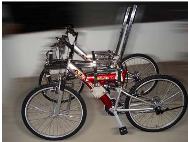
基本架構與兩台腳踏車組裝後之車體外型組裝方向控制連桿 (圖七)
