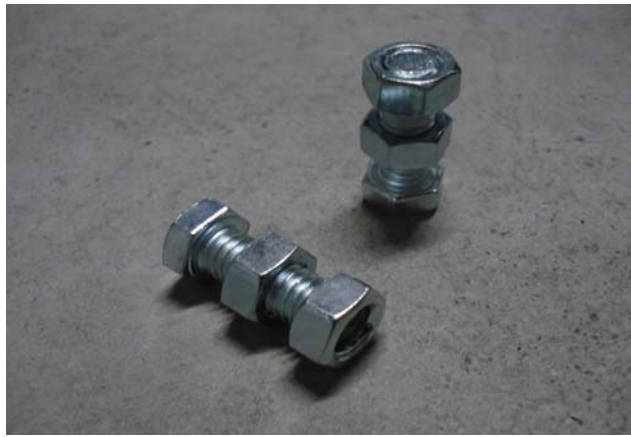
方向連桿以雙螺帽相互迫緊而不致鬆脫，使方向連桿仍能自由活動 (圖六)
