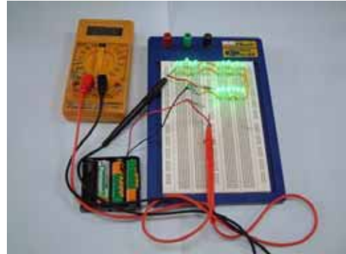
圖 56: LED 實際放電測量電流情形
