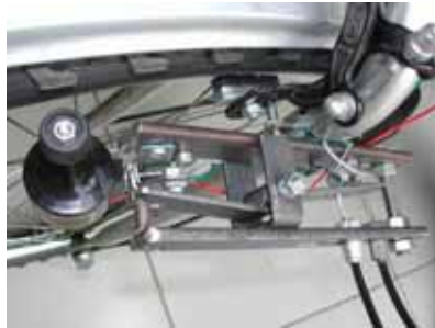
圖 25：未煞車時發電機離開車輪
