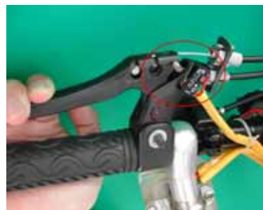
圖 28：煞車時 B 接點通可點亮煞車燈
