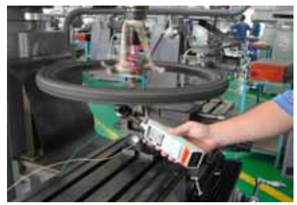
圖 46 :測量車輪及發電機轉速
