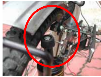
圖 24:自主發電機構作動情形接觸發電 ( 煞車片沒移動 )
