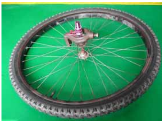
圖 51 :車輪利用夾具鎖緊
