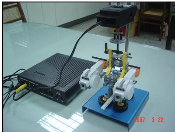
圖 5-8 輪子兩側均安裝步進馬達，模擬指南車前進或後退
