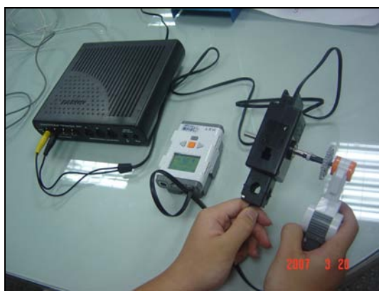
圖 5-6 (左起)PASCO 750 介面機、 NXT 主機、CI-6538 角度感應器、 NXT 步進馬達
